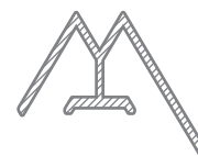
UA1453 23mm x 18mm 3mm Internal Corner 0.143 kg/m
